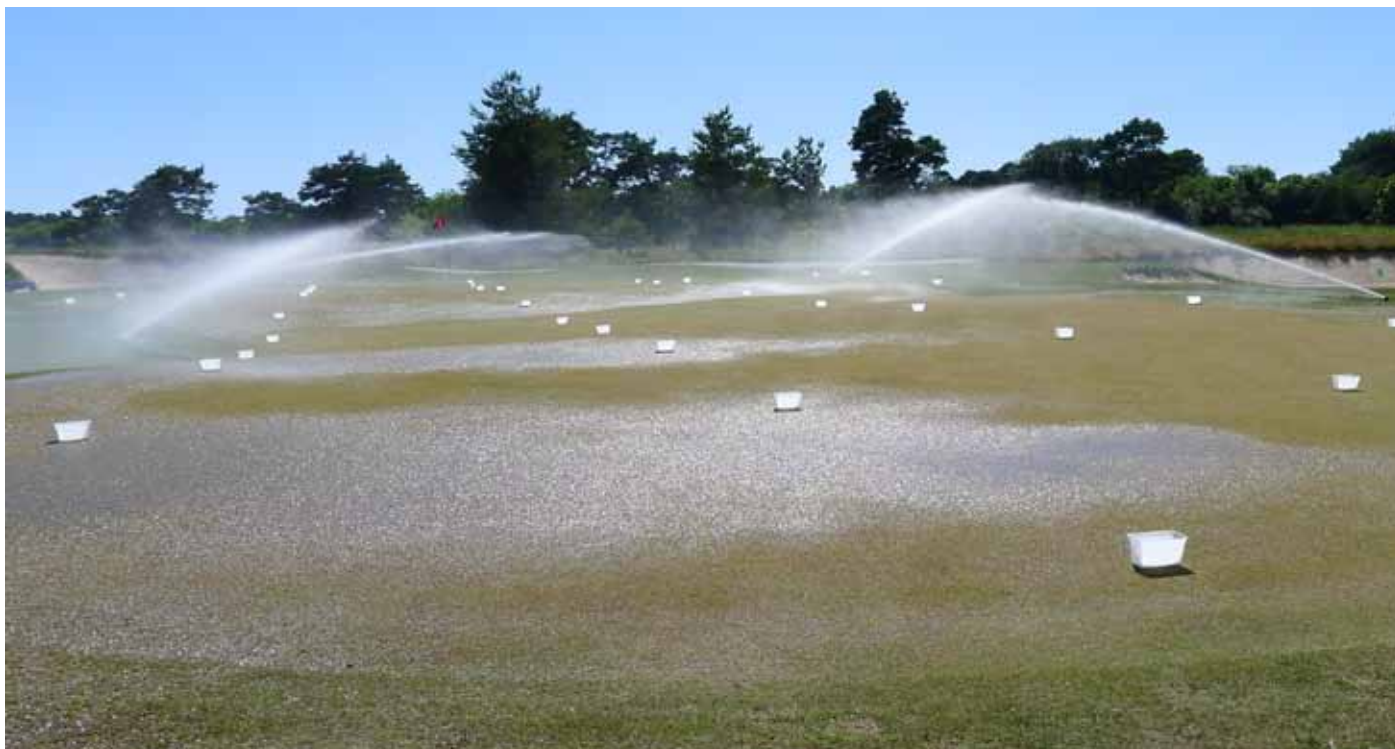
Bild 7. Intensiteten i en modern bevattningsanläggning är som regel högre än infiltrationskapaciteten. Detta leder till en ojämn bevattning även om sprinklerna är optimalt placerade. Bilden är från Visby golfklubb och visar en test med 10 minuters bevattning. Lägga märke till pölarna på greenen. Foto: Agnar Kvalbein
