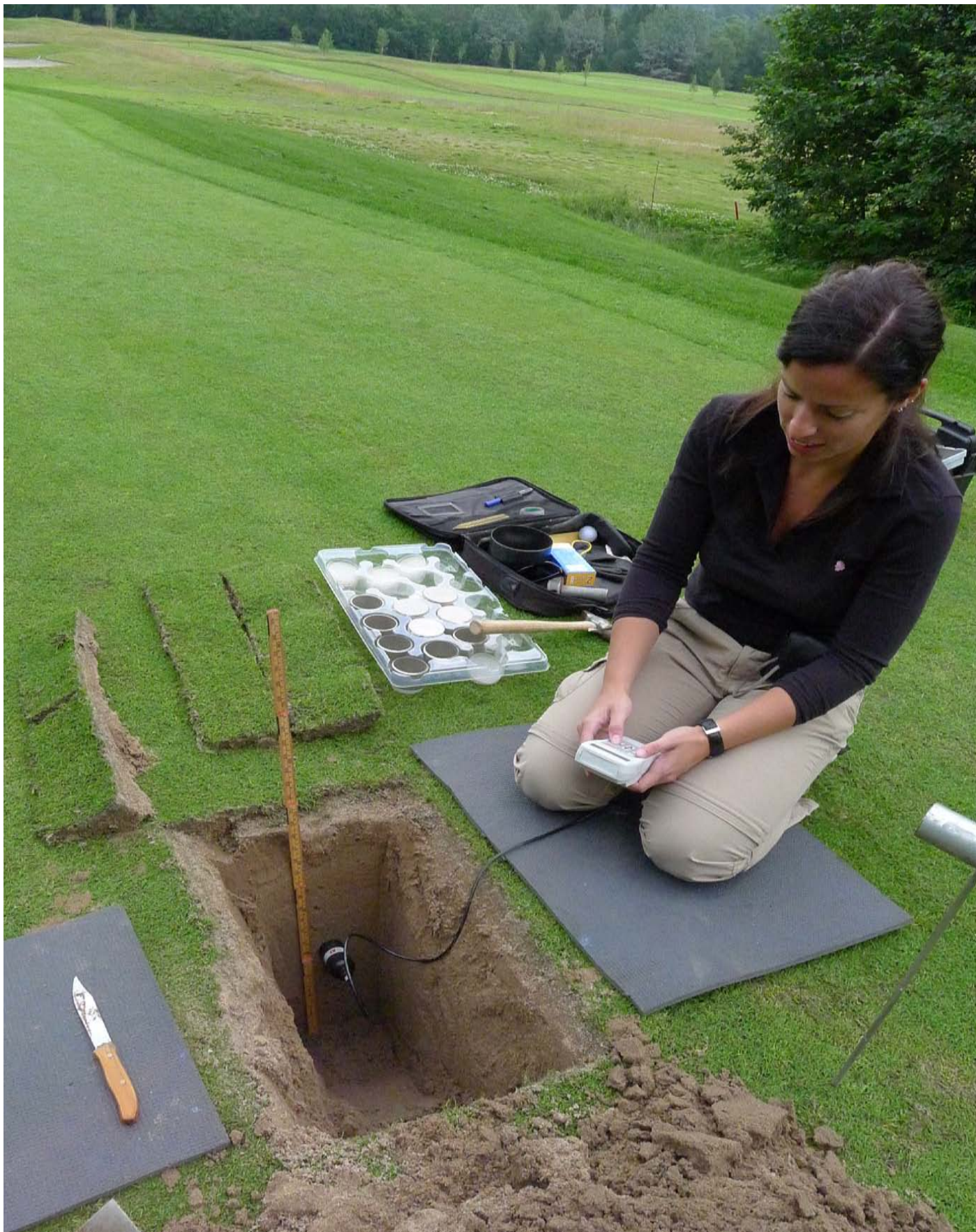
Kuva 3. Kasvualustan vesipitoisuus kasvaa lähestyttäessä salaojasorakerrosta USGA viheriöllä. Kuva:Agnar Kvalbein.
