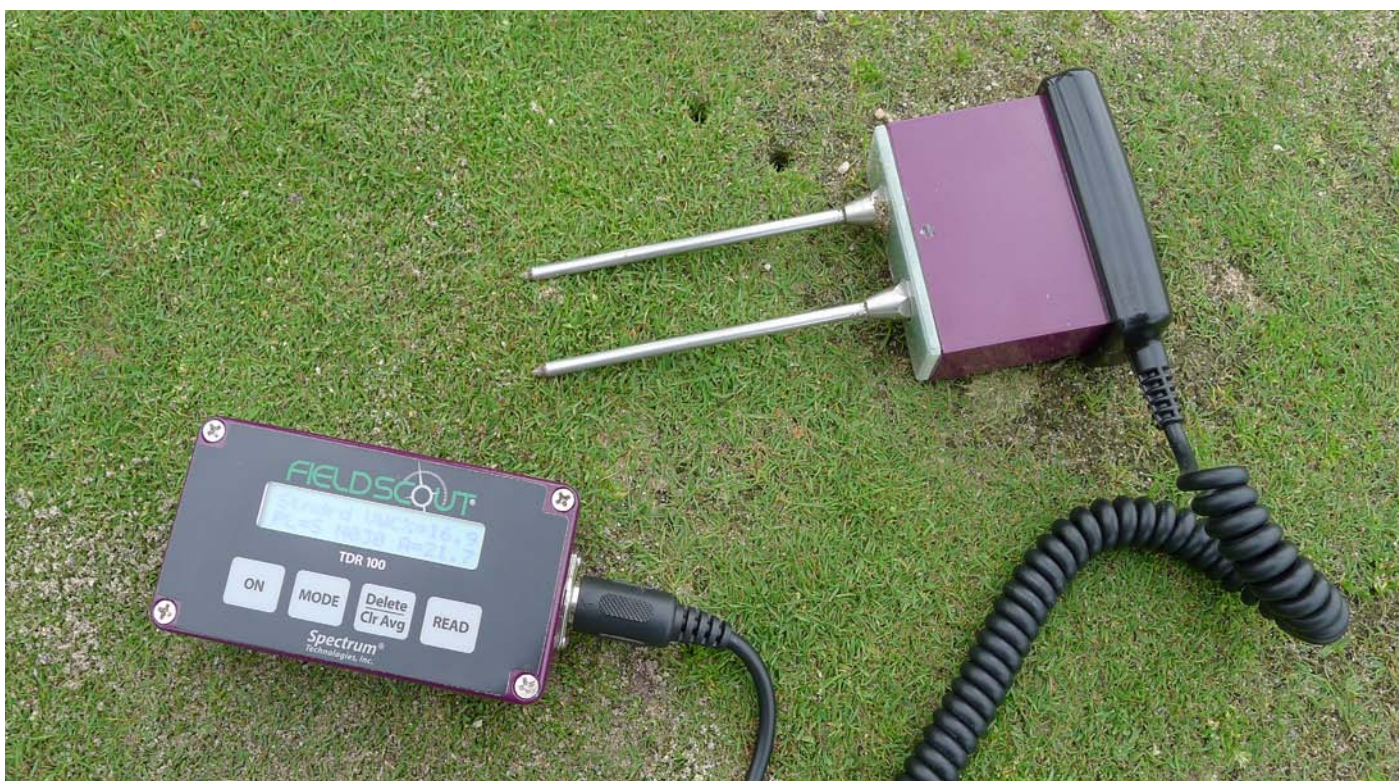
Kuva 10. Time Domain Reflectometri (TDR) -työkalua käytetään kasvualueen vesipitoisuuden mittaamiseen. Kuva: Agnar Kvalbein.
