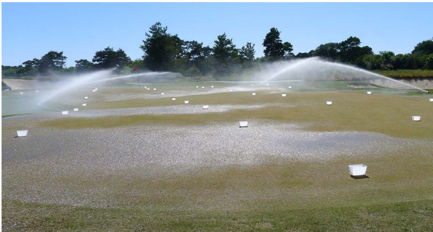
Kuva 11. Nykyaikaisen kastelujärjestelmän tuottavuus on usein korkeampi kuin kasvualustan läpäisykyky. Muodokkailla viheriöpinnoilla tämä aiheuttaa epätasaista veden jakautumista, vaikka sadettajat olisivat oikein asennettuja ja hyvin huollettuja. Tämä kuva (Visby GC, Ruotsi), osoittaa veden lammikoituvan viheriön matalille alueille levityksen tasalaatuisuus testissä (Distribution uniformity =DU). Kuva: Agnar Kvalbein.
