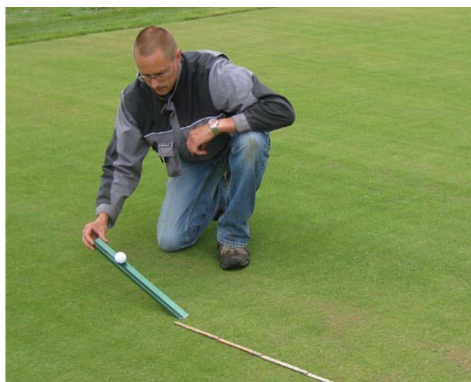
Kuva 4: Viheriönopeuden mittaaminen Primo Maxx -kokeissa. Koska koalueet eivät ole kuin 2 metriä pitkiä, käytettiin lyhyempää stimpimetriä. Kuva: Trygve S.Aamlid
