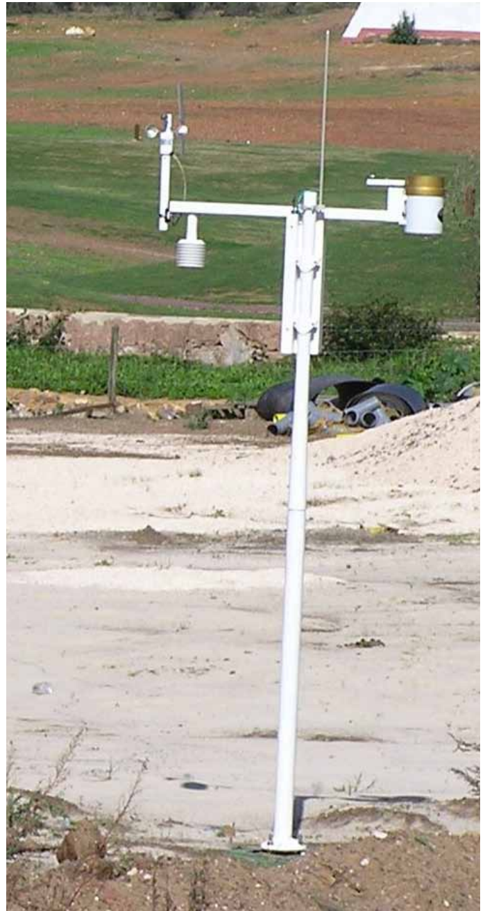
Billede 4. En vejrstation som beregner ET_0 kan kobles direkte til vandingsanlægget Foto: Agnar Kvalbein
