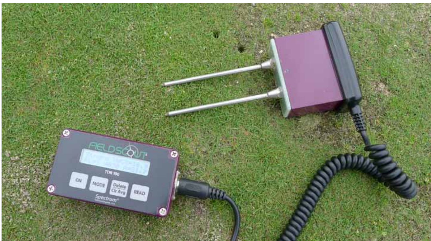
Time Domain Reflectometry (TDR), et instrument som måler vanninnholdet i jorda. Foto: Agnar Kvalbein
