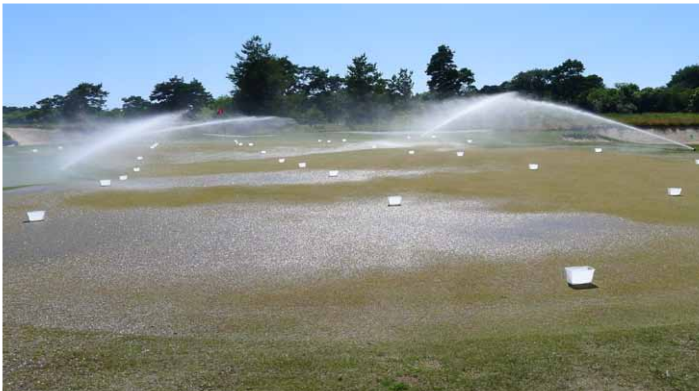
Bilde 7. Intensiteten i et moderne vanningsanlegg er som regel høyere enn infiltrasjonskapasiteten. Dette fører til ujevn vanning, selv om sprinklere står optimalt. Bildet fra Visby golfklubb viser en test med 10 minutters vanning. Legg merke til dammene på greenen. Foto: Agnar Kvalbein
