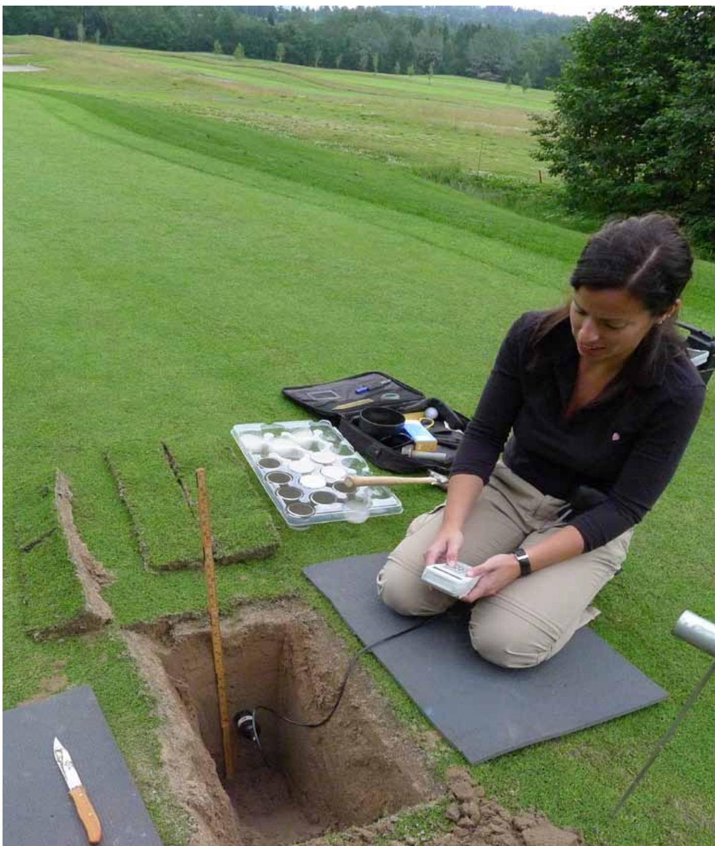
Vanninnholdet øker ned mot dreneringsgrusen i en USGA-green. Foto: Agnar Kvalbein.
