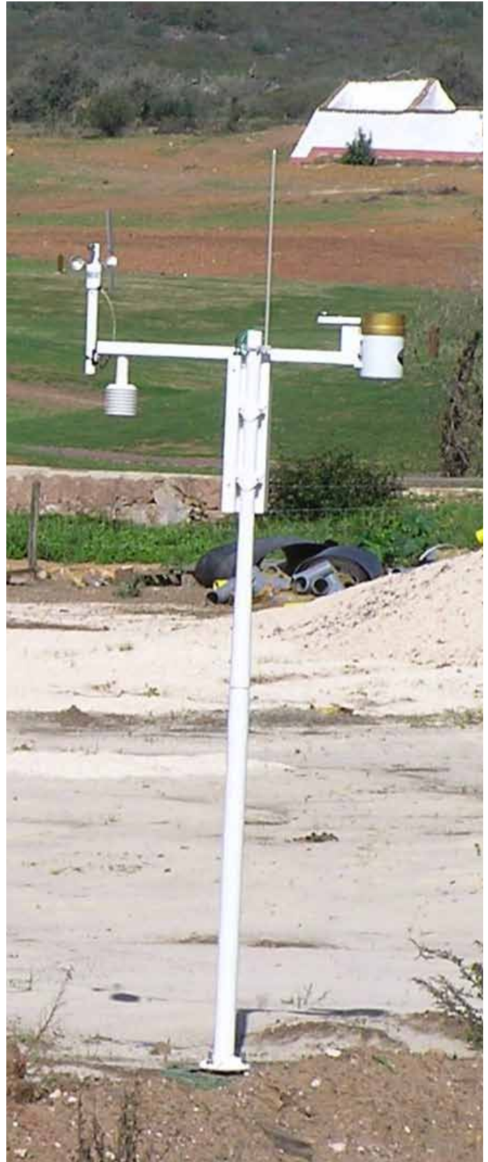
Bilde 4. En værstasjon som beregner ET_0 kan kobles direkte til vanningsanlegget. Foto: Agnar Kvalbein
