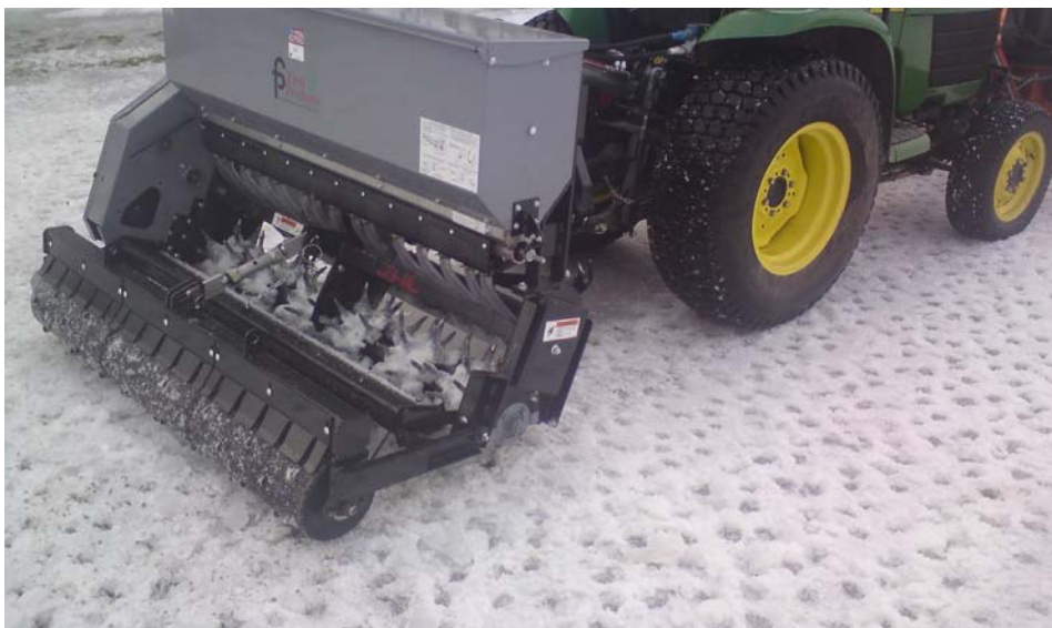
Denne maskine er populær ikke bare som såmaskine. De kraftige, vibrerende pinde kan knuse is. Foto: Tor Mjøen
