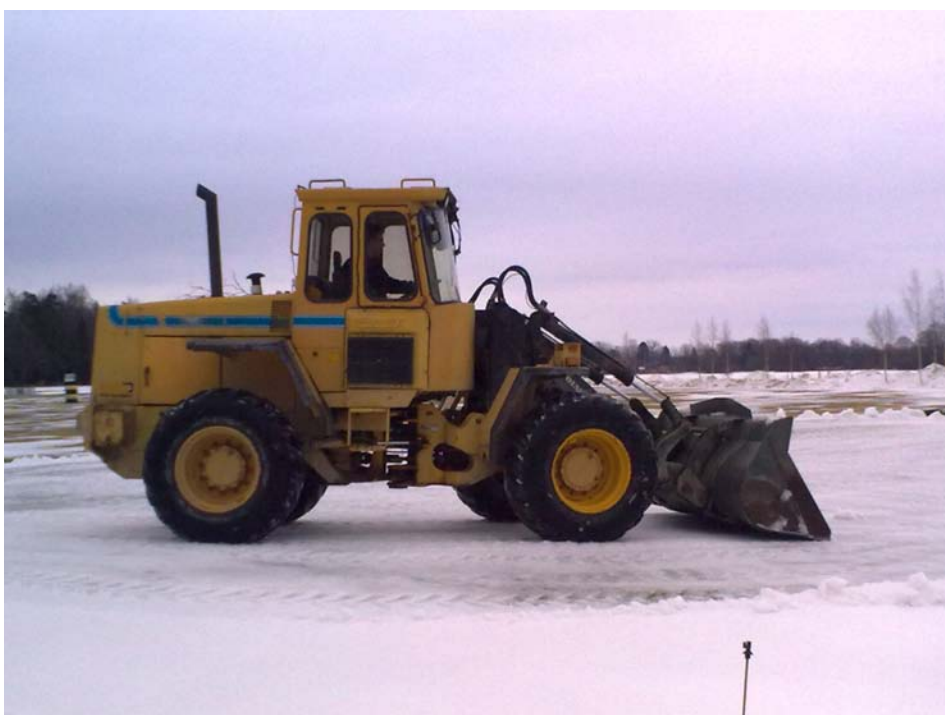
Hjullaster er ikke den mest vanlige maskinen på greener, men den kan brukes når det er dyp tele i bakken. Foto: Magnus Barth
