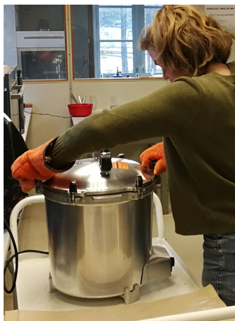
Bild 2. Kristine Sundsdal steriliserar glasrör med tillväxtmedium i en autoklav och gör dem klara för sådd (15 feb 2019). Foto: Tatsiana Espevig.
