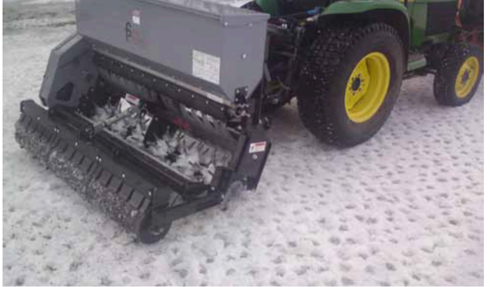
Tästä koneesta on tullut suosittu muutenkin kuin kylvössä. Värähtelevät kiinteät piikit voivat rikkoa jään. Kuva: Tor Mjøen
