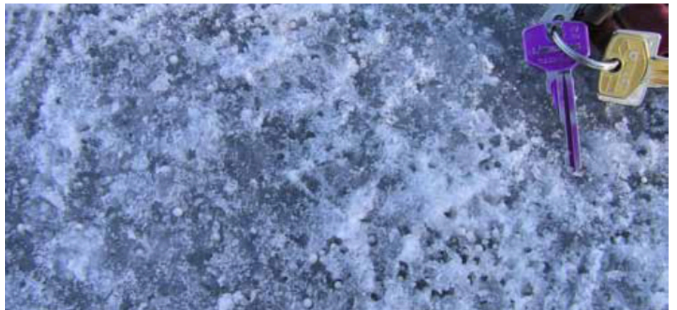
CMA tunkeutuu jään läpi, mutta ei ole kovin tehokas alhaisissa lämpötiloissa. Kuva: Agnar Kvalbein, Bærum GC, helmikuu 2008.
