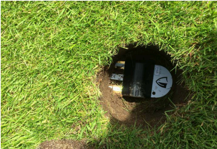
Kuvat 5 a,b. Maaperän tilavuusvesipitoisuutta mitataan jatkuvasti etäantureilla, jotka on asennettu 10 cm:n syvyyteen jokaiselle palstalle (vasemmalla) ja kolme kertaa viikossa TDR-laitteella, jossa on 20 cm:n piikit (oikealla). Etäanturiyksiköt on toimittanut norjalainen teknologiayritys Agdir luontoissuorituksena projektiin. Kuva: Trygve S. Aamlid.
