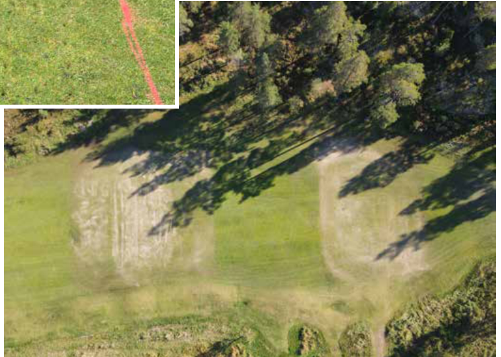
Kuva 3. Syväilmastusta Verti-Drainilla Kalundborgin golfkentällä 28. lokakuuta 2024. Kuva: Micki Truelsen.
