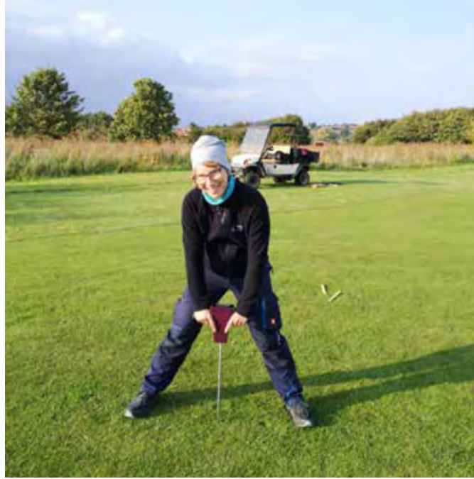
Kuva 2. Maaperän tiivistymistä mitataan
