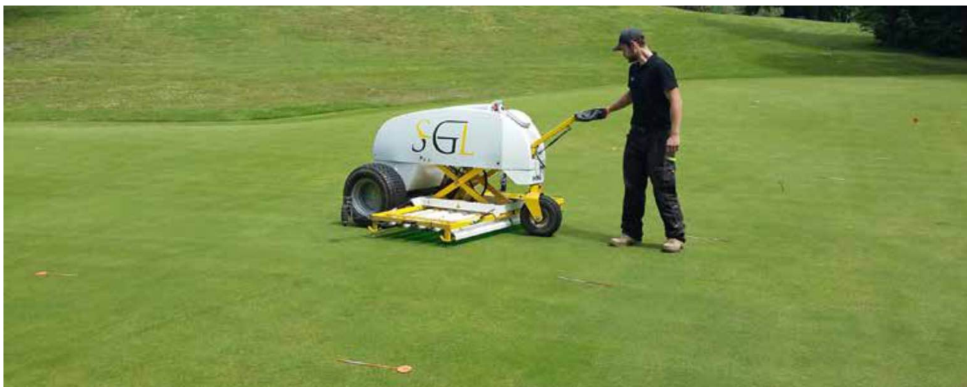
Kuva 19. UV-C-säteilytystä SGL UVC 180 -yksiköllä Osnabrück GC:n viheriöllä. Kuva: Wolfgang Prämaßing.
