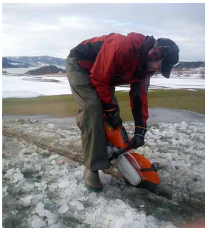
Foto 23. Tillfälliga diken i greenområden behöver underhåll under vintern. En asfaltskärare i bruk. Foto: Ole Albert Kjosnes, Byneset GC, Norge.
